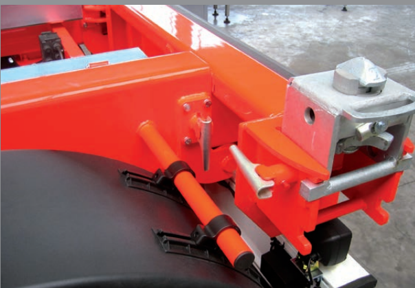
Verriegelung für Heckausschub
