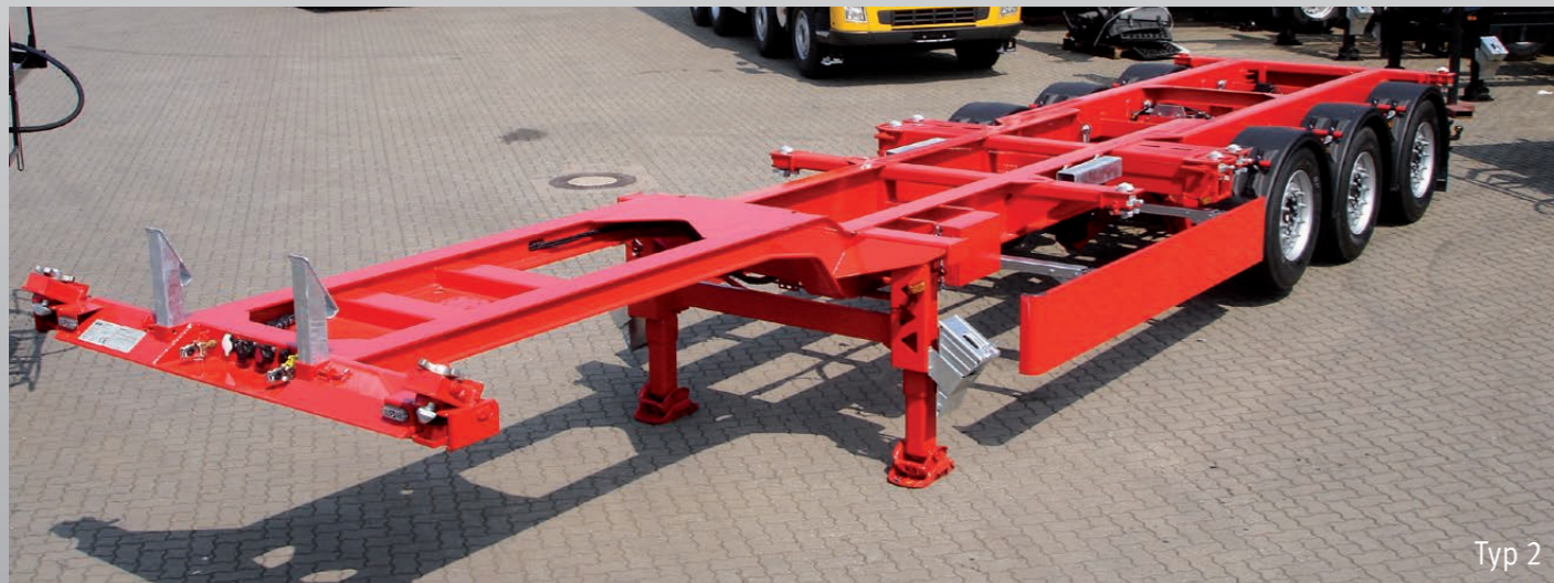
Containerchassis Typ CCS/HS mit Heckaus Schub
