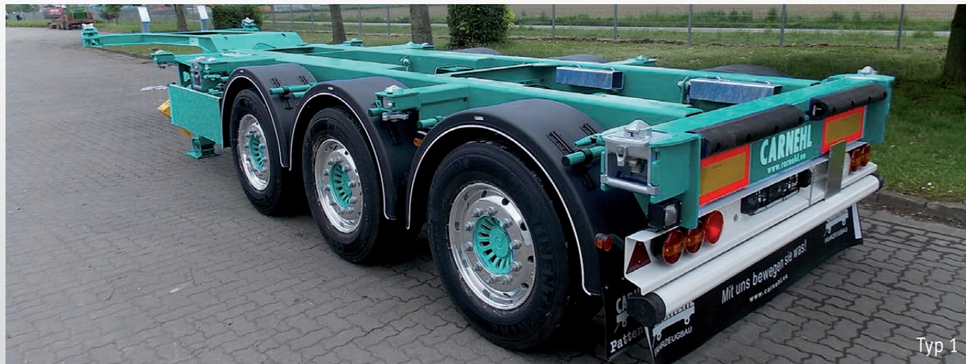
Containerchassis Typ CCS/MHS mit Mitten- und Heckaus Schub
